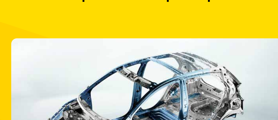
KHUNG GÁM MỚI - TĂNG TỈ LỆ THÉP CƯỜNG LỰC Tăng cường tỉ lệ thép cường lực, cải thiện độ bền kéo 12% so với sản phẩm hiện hữu, gia tăng độ chắc chắn cho khung xe
